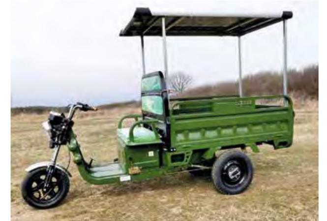
Das Cargo 500 mit dem Photovoltaik-Bausatz bringt eine Ladeleistung, die im Durchschnitt etwa 15 Kilometer Fahrleistung pro Tag ermöglicht, ohne das Ladegerät an eine Netz-Stromsteckdose an zu stecken.
